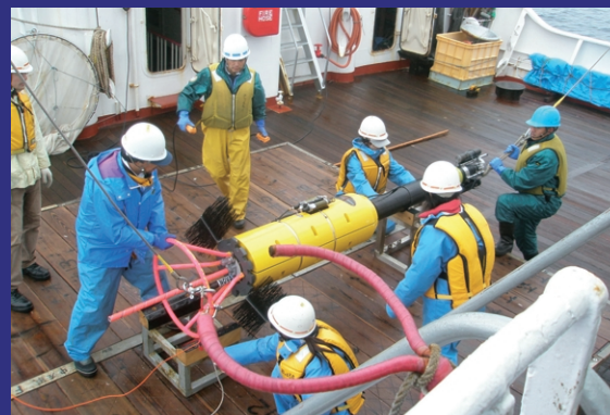
超深海乱流計を使った海洋観測。水深6000mまで自由落下しながら数cmスケール以下のマイクロな流れの強さを測定します。
