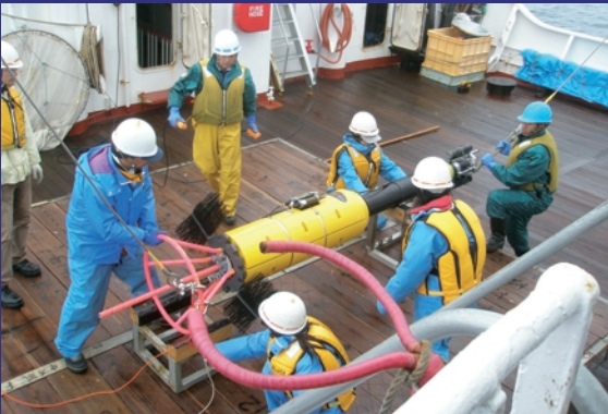
超深海乱流計を使った海洋観測。水深6000mまで自由落下しながら数cmスケール以下のマイクロな乱れの強さを測定します。
