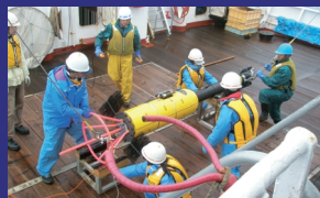
図2: 超深海乱流計を使った海洋観測。水深6000mまで自由落下しながら数cmスケール以下の流れの乱れの強さを測定します。
